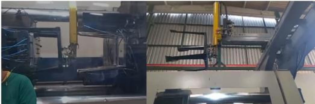
Figura 19. Mesa sendo produzida e retirada do molde pelo robô para o processo de acabamento.
