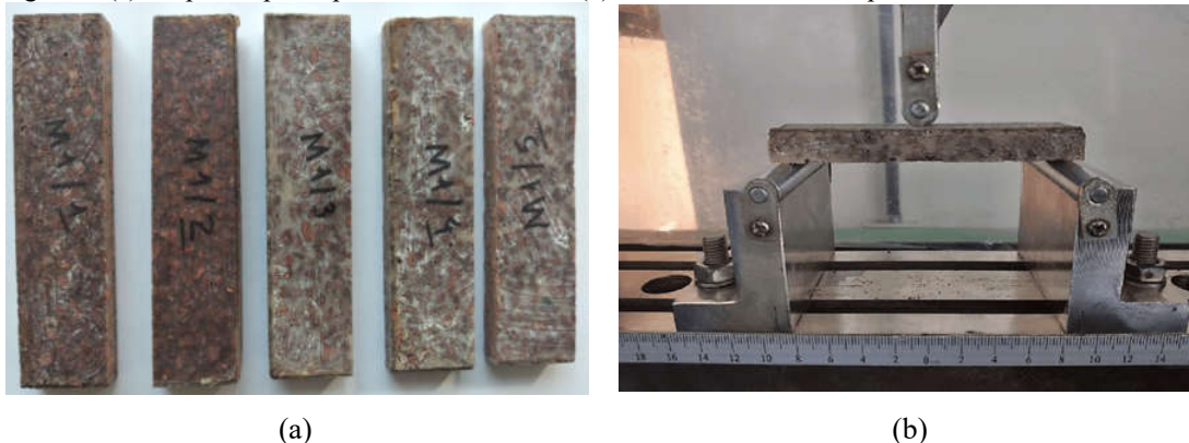
Figura 5: (a) Corpos de prova para ensaio de flexão. (b) Ensaio de flexão em 3 pontos
