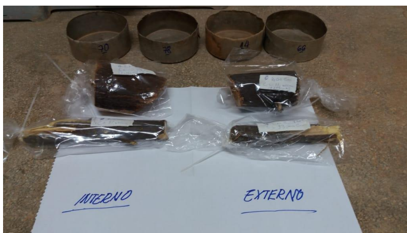
Figura 9 – Ensaio de umidade na lenha de Algaroba
