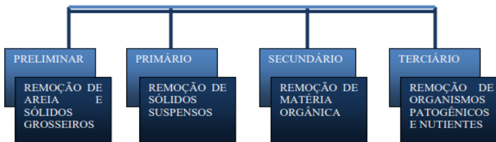
Figura 1. Etapas do tratamento de efluente doméstico e suas principais funções.
