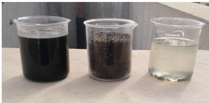
Figura 19. Lodo bruto, torta de lodo desaguada e efluente drenado.
