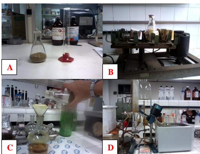
Figura 2: Etapas e processos para a obtenção dos extratos, etéreo e reunido, provenientes de C. substellata . A) Separação de resíduos; B) Agitação mecânica; C) Filtragem; D) Secagem em banho-maria acoplado a rotaevaporador.
