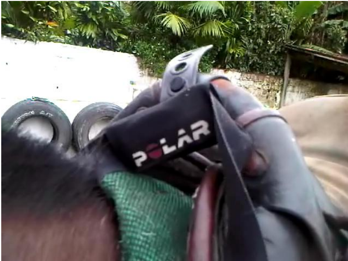
Foto 3 Receptor dos transdutores devidamente posicionado no arco da sela
