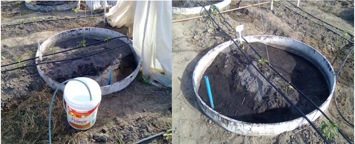
Figura 1. Saturação do solo nos lisímetros
