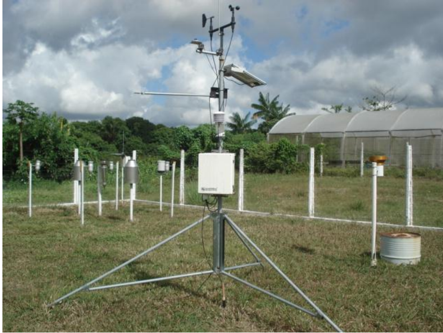
Figura 5. Estação meteorológica da UFRPE (Campbell Scientific)
