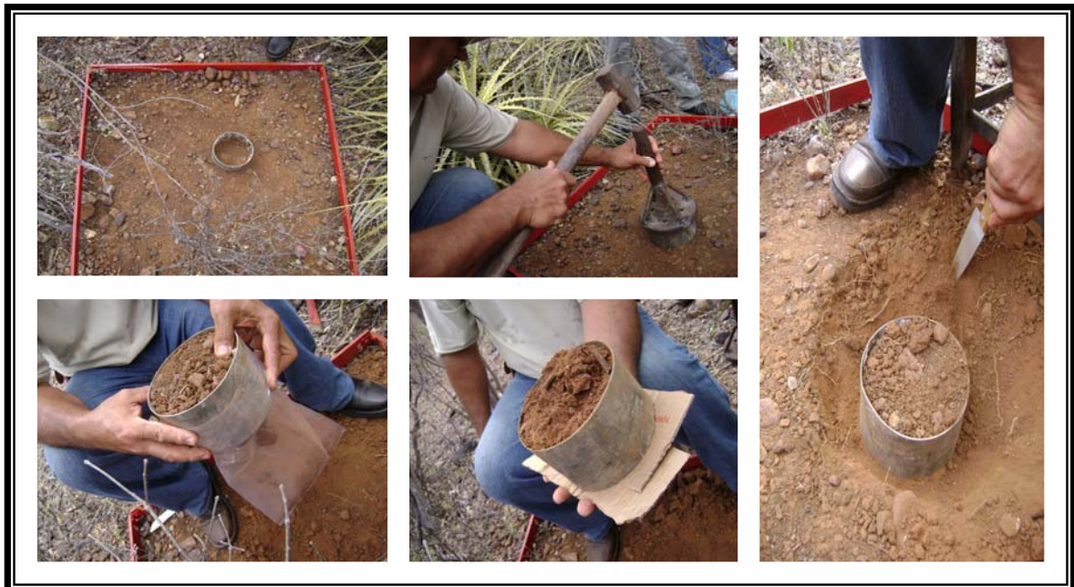
Figura 5. Etapas da coleta de solo utilizando anel amostrador de aço inox para as três profundidades de solo coletadas (0-10; 10-20 e 20-30cm).
