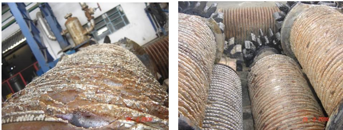
Figura 2. Moendas desgastadas pelas impurezas minerais no processo de moagem da cana.
