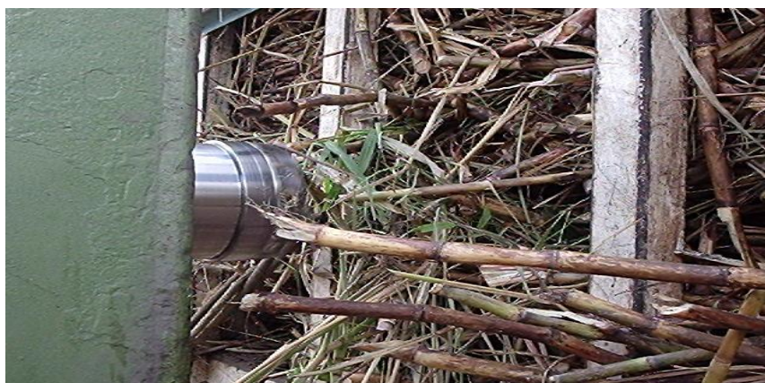
Figura 3. Aspecto da amostragem através de sonda
